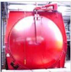
Autoclave de grande capacité pour vulcanisation sous pression à température élevée
